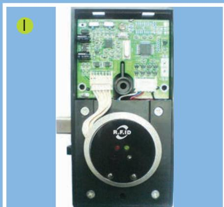
型號：0200電子式感應鎖 (離線型)
